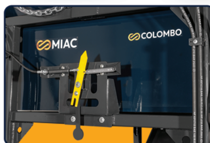
Mecanismo de fácil visualização da compensação de nível da peneira vibratória.
