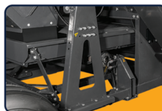
Central de lubrificação
