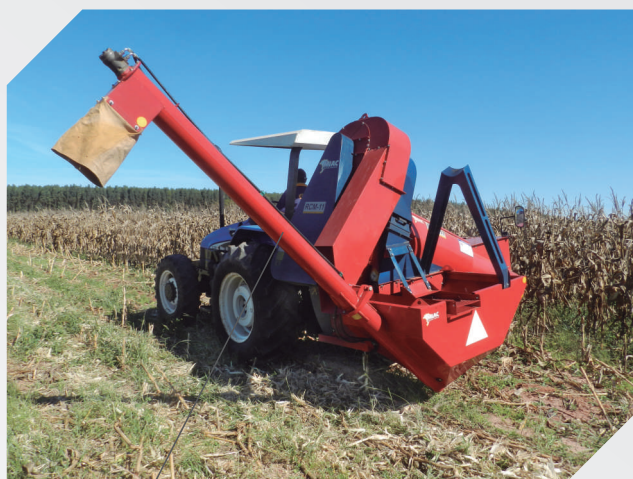
Sistema de descarga acionado hidraulicamente
