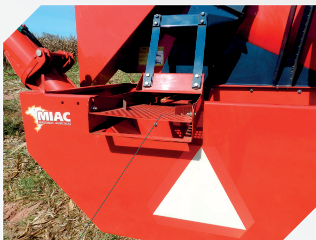
Sistema de limpeza composto por peneiras com eliminação de impurezas através da turbina de sucção
