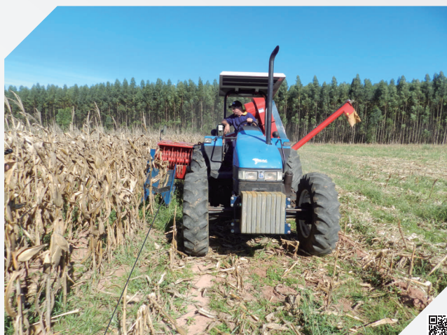
Sistema de despigamento tipo "pirulito"
