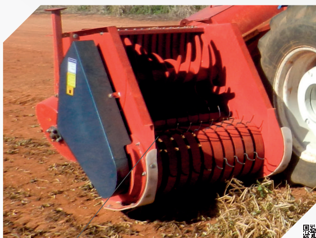
Plataforma recolhadora de feijão com 800 mm de largura
