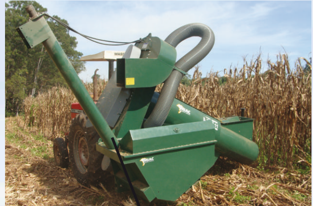
Hydraulic discharge system | Sistema de descarga con accionamiento hidráulico
