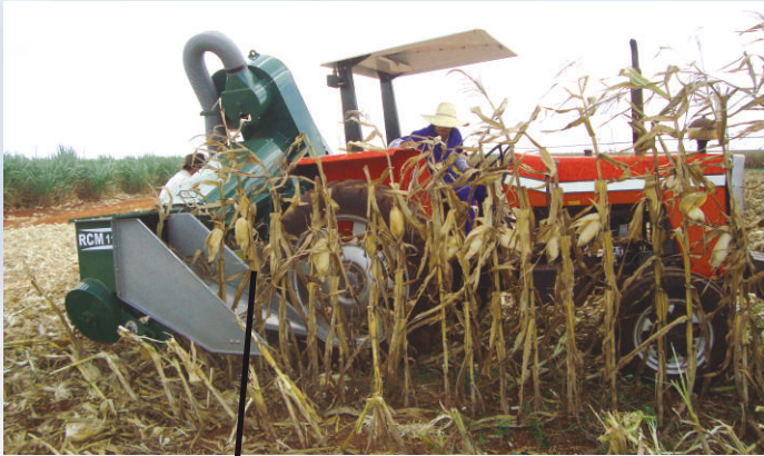
Harvesting system with chains | Sistema de cosecha de maíz con cadenas y espirales
